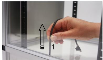
» Klipsen Sie den Temperatursensor (1) an der gewünschten Position wieder in eine Rasterschiene (2) hinein.
