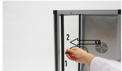
» Drücken Sie die Führungsschienen (3) waagrecht und paarweise auf beiden Seiten in die Rasterschienen (2) hinein. Die Führungsschiene (3) rastet hörbar in die Rasterschiene (2) ein. Zur besseren Orientierung sind auf den Rasterschienen (2) Zahlen vorhanden.
