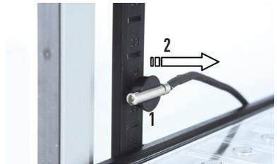
» Afin de changer la position, retirez l'étrier avec la sonde de température (1) du dispositif de suspension (2).
