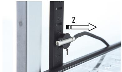
» Zum Verändern der Position, ziehen Sie den Halter mit dem Temperatursensor (1) von der Rasterschiene (2) ab.
