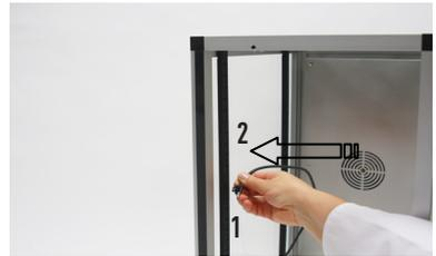
» Montez les guides (3) horizontalement par paires et en la même hauteur sur les deux côtés du dispositif de suspension. Les guides (3) enclenchent audiblement. Vous trouverez des chiffres sur le dispositif de suspension (2) pour identifier simplement les niveaux différents.
